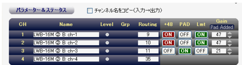
CH1 ~ CH3 がマイク・チャンネルとルーティングされている例
