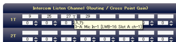
[Routing] ボタンを選択し、スロット H の CH1 の表示をクリックしたとき：各チャンネルのルーティング No. が表示されています
