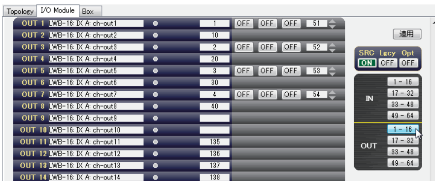
MADI モジュール表示中に OUT の [1-16] ボタンをクリックした直後の [I/O Module] タブ
