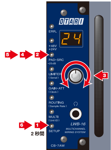
同時ルーティング・チャンネル数を 入力チャンネルは 2 に 出力チャンネルは 4 に
