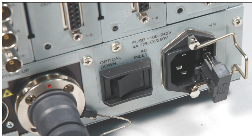
AC インレットのヒューズ・ホルダー ※写真は初期の頃の LWB-64
