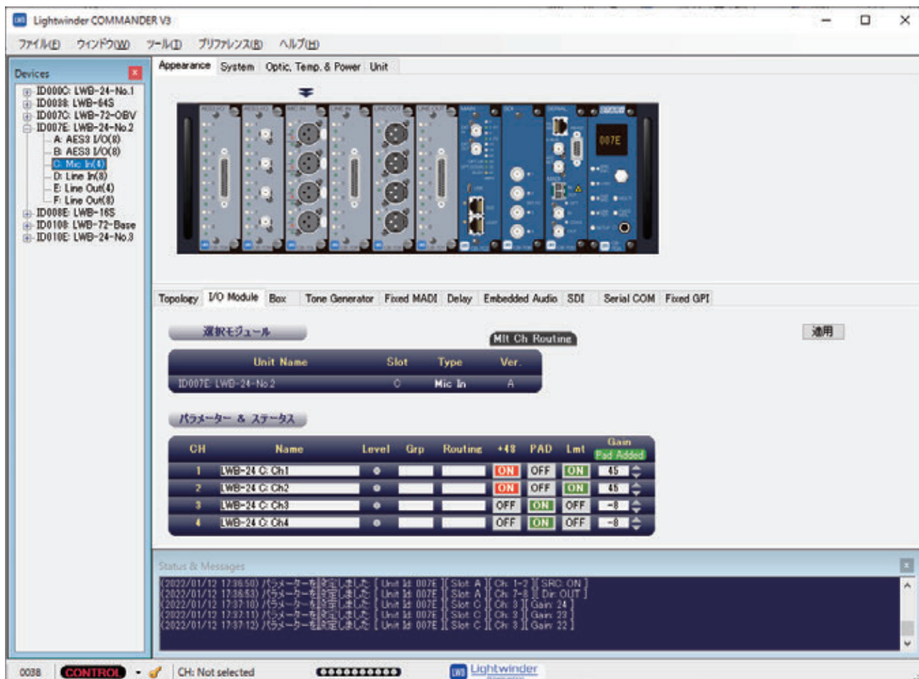
デバイス・ウィンドウで選択したユニット ID007E の LWB-24 の Slot C の MIC モジュールを [I/O Module] タブに表示。 [Appearance] タブで当該モジュールをクリックしても同じ
