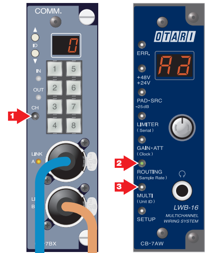
LWB-16M/64 において本線 B および GPI チャンネルを選ぶ場合
