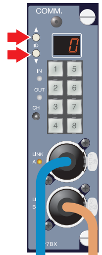
ID スイッチを押して変更したいボックスの ID 番号を表示させる
